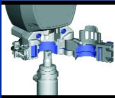
3 Ta ut pinnen Pumpedelen er løs
